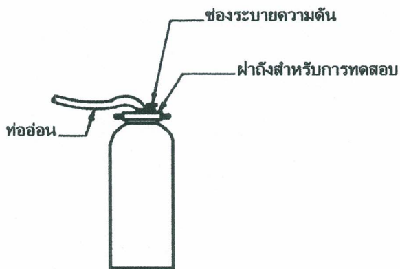
รูปที่ ก.2 อุปกรณ์ประกอบสำหรับทดสอบ (ข้อ ก.1.2 และข้อ ก.3.2)
